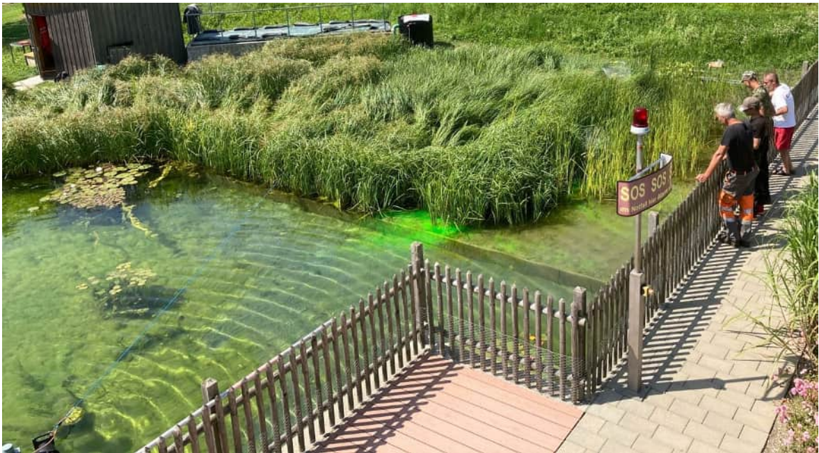
Abbildung 13: Färbetest in einem Filtersegment, eingefärbt über einen Beschickungsschacht, 21.07.2021
