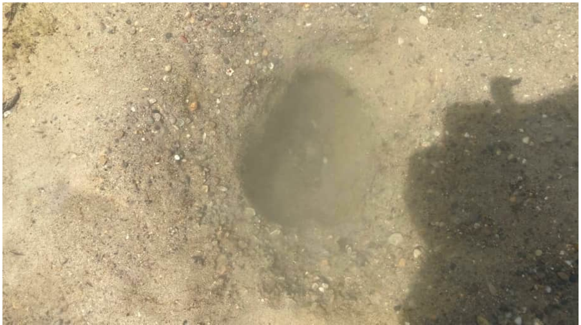
Abbildung 11: Verhärtete, kolmatisierte Substratschicht im Filter saugseitig, 08.07.2021
